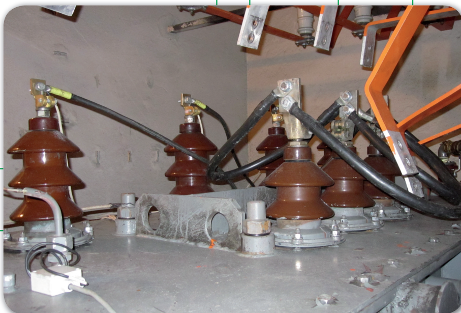
Připojení zařízení LFHE-II na vývody transformátoru. NN strana - nakrátko, VN strana - napájecí a měřicí kabel od zařízení LFHE-II.
